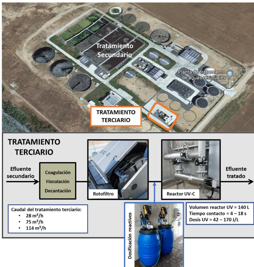
Figura 1. Vista aérea de la EDAR (arriba) y esquema del tratamiento terciario (abajo) (Fuente: Google Maps)
