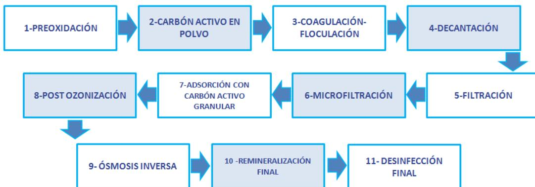
Figura 1: Etapas del proceso de la planta piloto.
