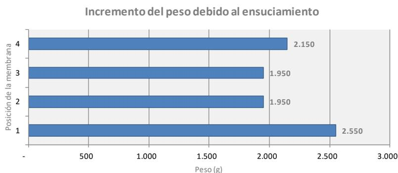
Figura 8 Pesaje de las membranas
