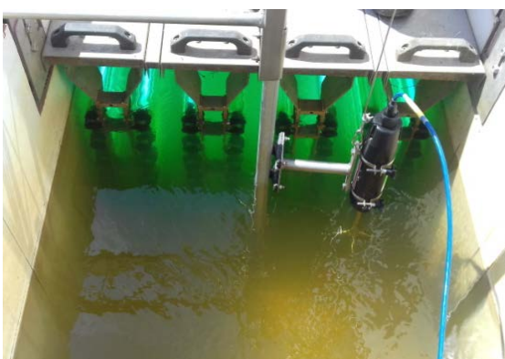
Figura 7. Adquisición de la señal en superficie, posición C sin deflector 2 (izq). Componentes de la velocidad (derecha).
