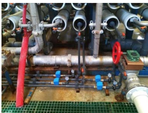
Figura 3. Tubos de presión adaptados para la validación de membranas recicladas de NF para el tratamiento de agua salobre.
