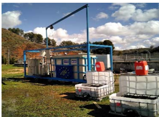
Figura 2. Planta piloto para la validación de membranas recicladas de UF como tratamiento terciario de aguas residuales.
