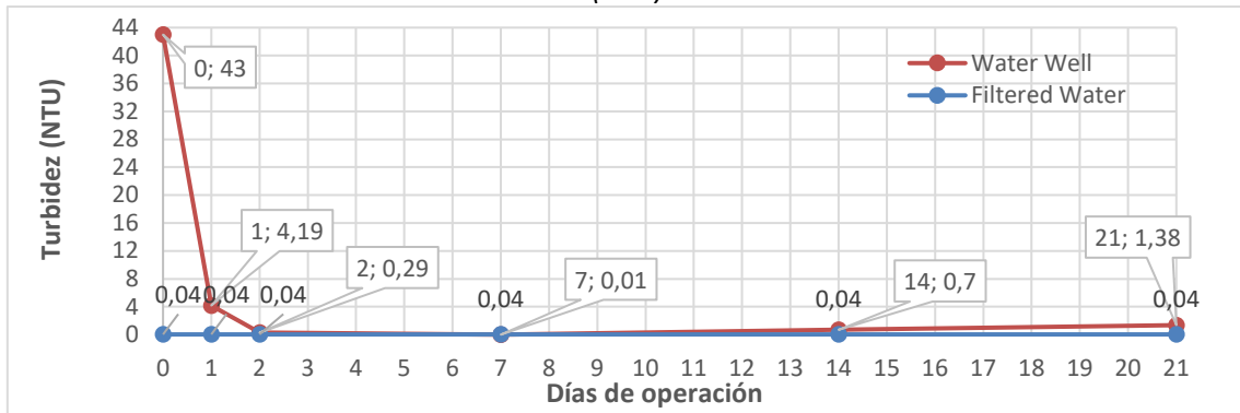
Figura 4. Valores de la turbidez del agua de pozo y el agua filtrada con respecto al tiempo (días)
