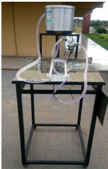
Figura 2 . Fotorreactor, con el uso de la radiación solar utilizado en experimentos de irradiación, que contiene la solución de colorante amaranto.
